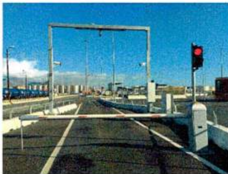
Figura 2 - Tipologia di barriera con semaforo
