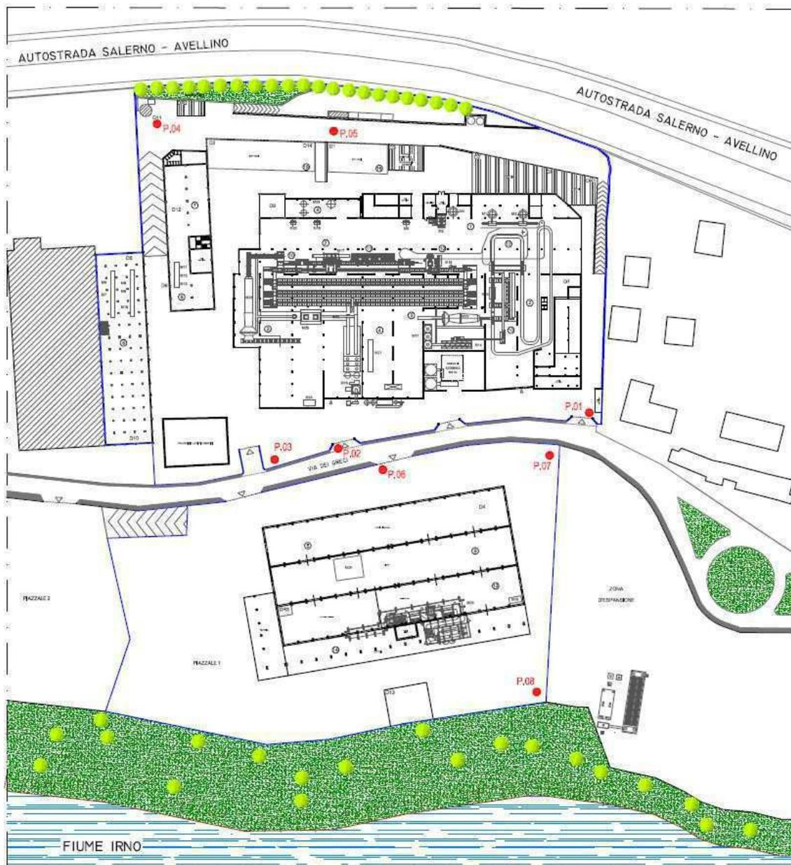
**Figura 3 - Estratto planimetria con punti di misura fonometrici**
